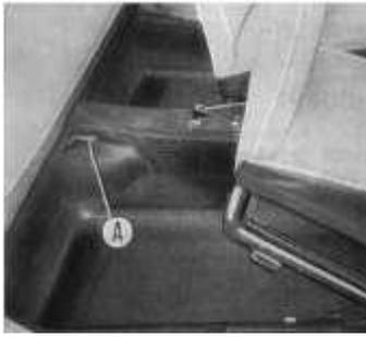
además de girar hacia la derecha la palanca (A) es menester actuar sobre el tirante (B) con lo que se varía la orientación de la mariposa interior de la caja de distribución, permitiendo la salida de aire caliente por las ventanillas (C). Para activar la circulación del aire en el interior del coche,
