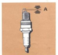
celana del electrodo central y el cuerpo de la bujía -es conveniente hacerlo con chorro de arena- v controlar que la luz entre electrodos A sea de 0,5-0,6 mm.
