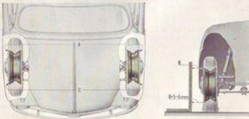
Fig. 35. — Control de la convergencia e inclinación de las ruedas anteriores (con coche a plena carga).
