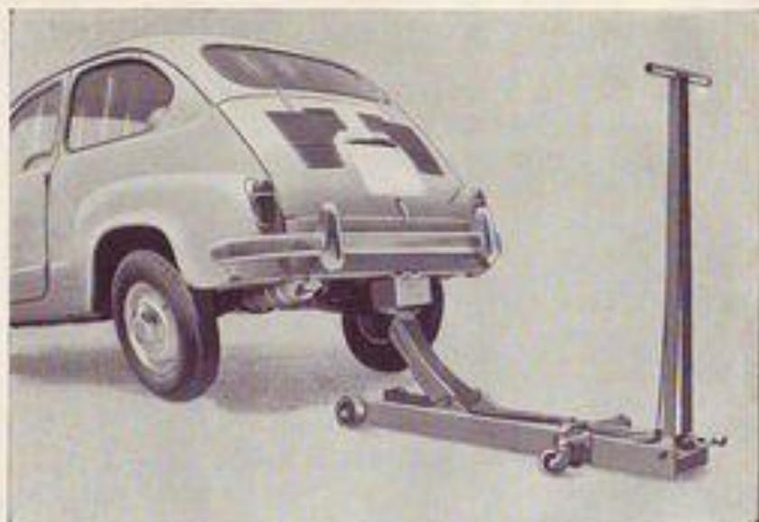
Fig. 43. — Levantamiento del coche por la parte posterior, con elevador hidráulico.
