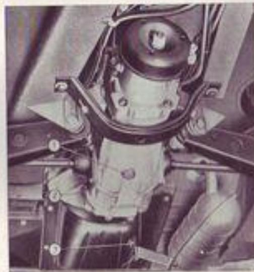
Fig. 30. — Grupo motor-cambio diferencial, visto por debajo.
