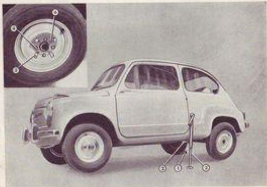
Fig. 41. — Levantamiento del coche con gato.
