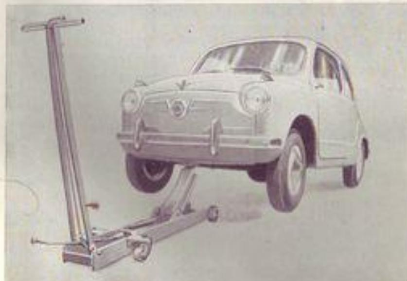
Fig. 42. — Levantamiento del coche por la parte anterior, con elevador hidráulico.
