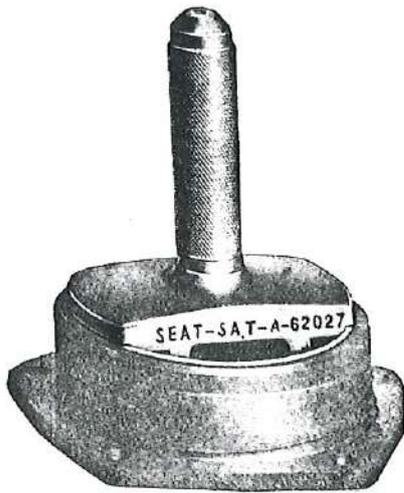
Fig. 204 - Montaje, mediante el útil A. 62027, del anillo exterior del rodamiento a rodillos, para caja interna del diferencial, en la caja porta-rodamiento.
