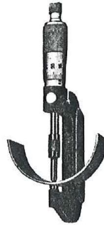
Fig. 68 - Control del espesor de un semicojinete, mediante micrómetro.
