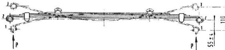
Fig. 229 - Oscilaciones de la ballesta, montada sobre el coche.
